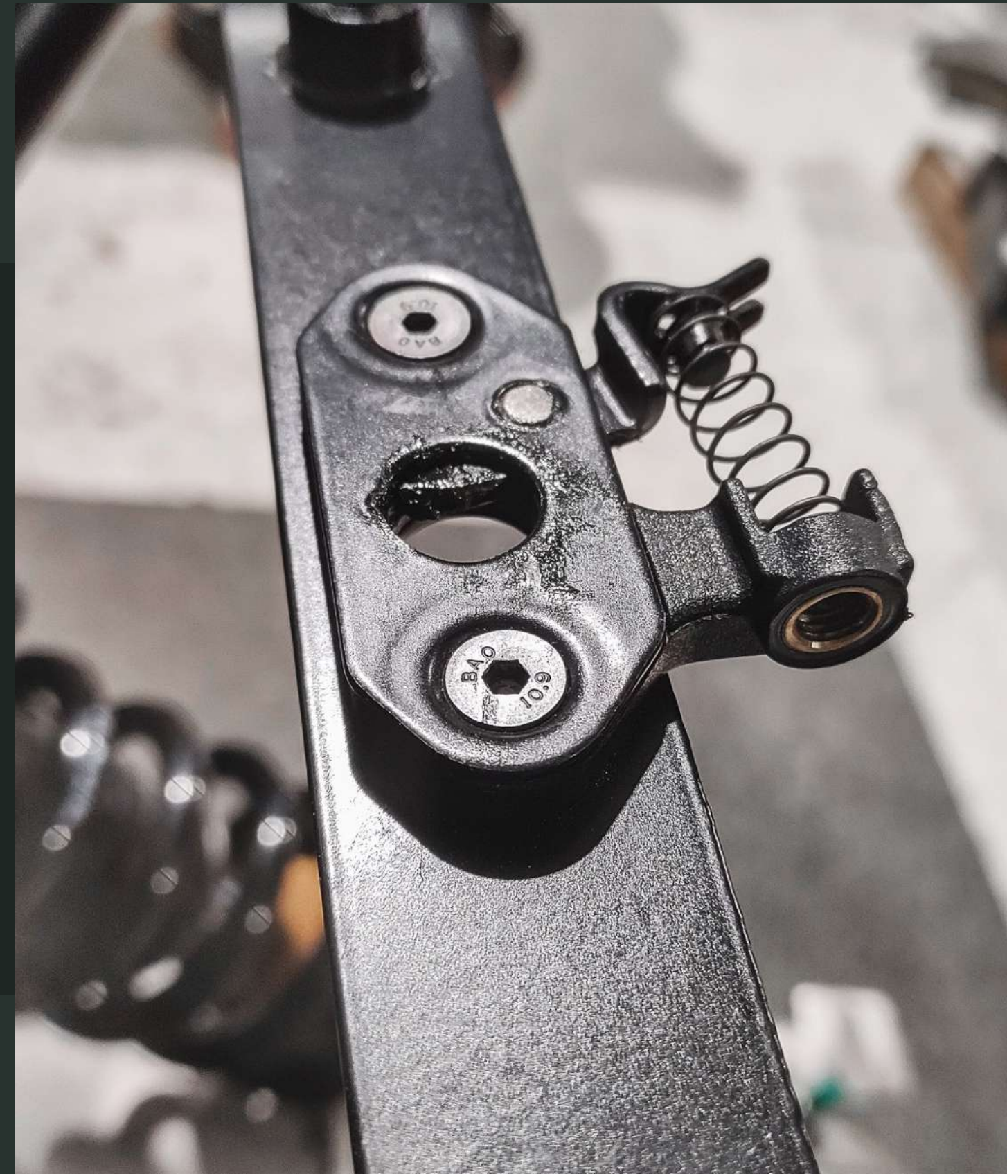
Seat « quick release » system
